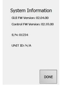
Les champs « GUI FW version » et « Control FW version » affichent la dernière version de microprogramme installée sur l'instrument.
